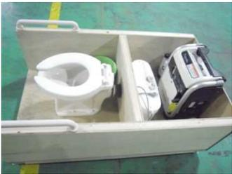
「510型どこでもトイレ」はプロパンガスのカセットボンベを燃料とした発電機と排水圧送ポンプ、水中ポンプをセットしたトイレです
