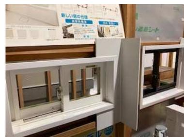
YKK-APのマドリモを展示しています。システムバス設置の場合、まわりのコンクリートを削ってサッシを取り替えるのは大変です。既存枠を利用してリモデルができるマドリモをおすすめします。
