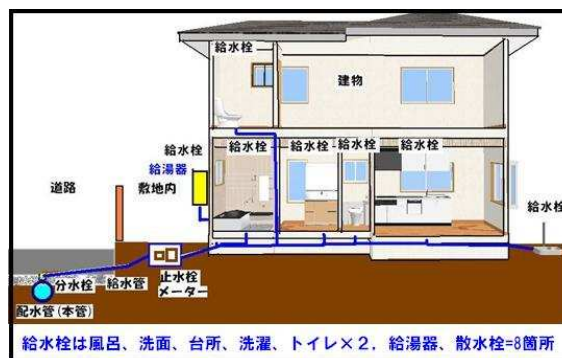
画2 給水系統標準的な住宅で8箇所の給水栓
